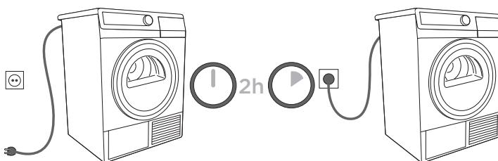
Перед подключением к электросети оставьте прибор при комнатной температуре на 2 часа.
