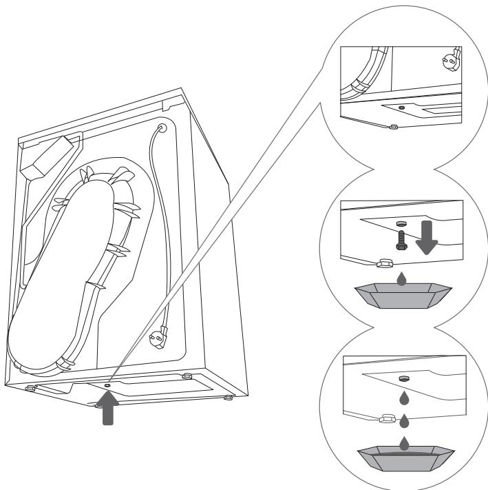
**1** Слив емкости парогенератора находится в днище прибора с задней стороны слева.
