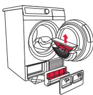
**1** Deschideți ușa uscătorului și **curățați filtrele** (vezi secțiunea Curățare).
