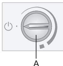
**Stänga av:** Vrid knappen **A** tillbaka till läget där pilen är inriktad med symbolen  $\ominus$  (apparaten är fortfarande strömansluten, dvs. det finns fortfarande elektrisk ström i den).
