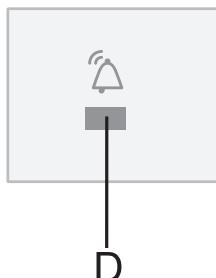
Om temperaturen i apparaten är för hög avges ett larm (indikatorlampan **D** blinkar). När temperaturen i kylskåpet sjunker till en nivå som inte längre utgör en risk för att mat förstörs, släcks lampan automatiskt.
