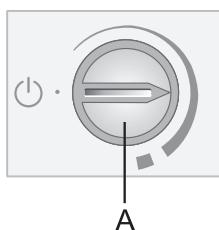
För att slå på: vrid termostatkoppen **A** medurs mot den tjockare änden av markeringen.
