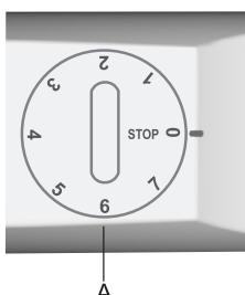
Viši položaji na dugmetu termostata (prema brojci 7) znaće nižu temperaturu (hladnije) u svim delovima aparata. Temperatura u unutrašnjosti frižidera može da se spusti i ispod 0 °C. Više položaje koristite samo kada je tražena i preporučljiva niža temperatura hlađenja, ili ako je temperatura okoline niža od 16 °C. Na normalnoj temperaturi okoline preporučujemo srednju regulaciju.
