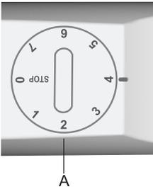
**Einschalten:** Drehen Sie den Thermostatknobel im Uhrzeigersinn in Richtung der Position **7**.
