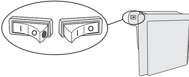
Lorsque l'ioniseur est en marche, un point rouge est visible sur l'interrupteur.
