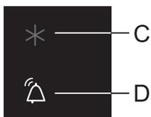
Lorsque l'appareil vient d'être branché au réseau électrique pour la première fois, ou que la température est trop haute dans le réfrigérateur (plus de 13°C), un signal sonore intermittent retentit et l'icône **D** clignote.
