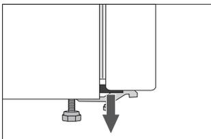
An den Ecken der Geräteür sind Distanzhalter angebracht, die Sie entfernen und durch die mitgelieferten Stöpsel (nur bei einigen Modellen) ersetzen.
