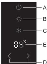
**VitaLED:** Durch Drücken der Taste **B** wird die Funktion VitaLED ein- bzw. ausgeschaltet. Beim Einschalten leuchtet die Taste **B**. Wenn die Funktion aktiviert ist, leuchtet die orangefarbene **LED**-Leuchte des Obst- und Gemüsefachs.
