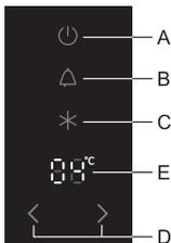
Bei überhöhter Temperatur im Geräteinneren wird ein akustischer Alarm (unterbrochener Ton) ausgelöst und die Taste **B** blinkt.
