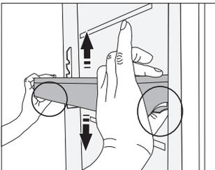
Sie können die Ablagen beliebig in der Höhe verstellen, ohne diese aus dem Gerät nehmen zu müssen. Drücken Sie die Zungen an jeder Seite und schieben Sie einfach den Behälter nach oben oder nach unten.
