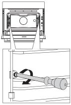
Desaperte os parafusos com uma chave de fenda.
