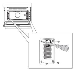
Desaperte os quatro parafusos na tampa. Retire a tampa e o vidro.
