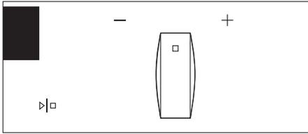
**1** Gire el SELECTOR DE AJUSTES (-/+), primero los minutos; a continuación el cursor cambiará a las horas. Después de tres segundos, se guardará el ajuste.
