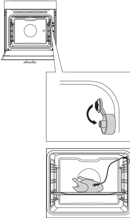
**1** Retire el tapón de metal (el conector se encuentra en la esquina superior delantera de la pared derecha).
