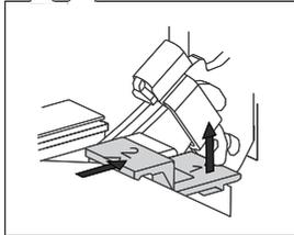
**1** Levante ligeramente los soportes situados a la derecha y la izquierda de la puerta (marca 1 en el soporte) y retírelos de la hoja de cristal (marca 2 en el soporte).
