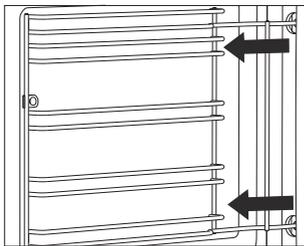
**2** Extraiga las guías de los orificios de la pared trasera.
