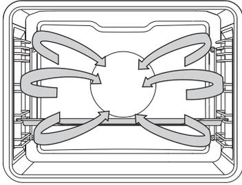
Se accionarán el calentador circular y el ventilador. El ventilador instalado en la pared trasera del horno hace que el aire caliente circule constantemente alrededor del asado o de la masa.
