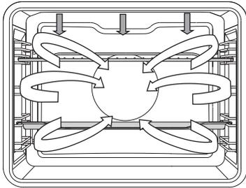
En este modo de funcionamiento, el calentador del grill y el ventilador se activan simultáneamente. Adecuado para hornear carnes, pescado y verdura.
