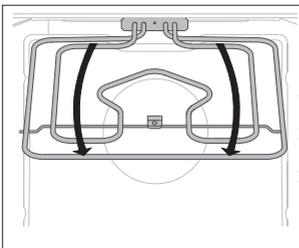
**1** Para extraer el calentador, afloje el tornillo situado en la parte delantera de la bóveda del horno.
