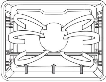
Se utiliza para hornear masa fermentada pero de bajo crecimiento y para preparar conservas de frutas y verduras. Utilice la segunda guía desde abajo y una bandeja de horneado poco profunda para permitir que el aire caliente circule por la parte superior del plato.
