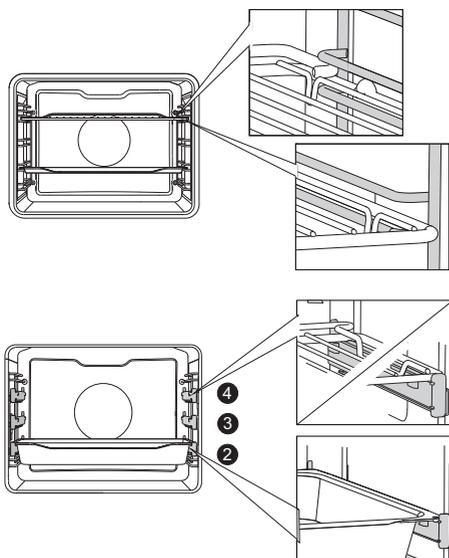
Con guías extensibles telescópicas, primero extraiga las guías de un nivel y coloque la parrilla o la bandeja de horneado sobre ellas. A continuación, empújelas con la mano hasta el final de su recorrido.
