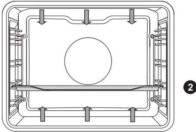
Los calentadores situados en la bóveda y la solera del horno irradian calor de forma uniforme en el interior del horno.
