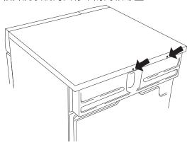
3. 根据图示说明,使用螺丝固定防倾覆装置。
