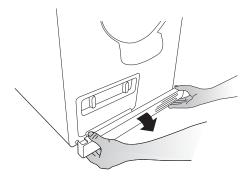
3. 旋转两个旋钮, 打开冷凝器面板。
