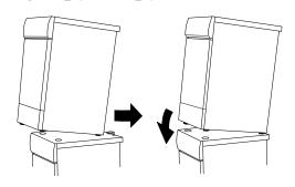
7. 将滚筒式干衣机的前脚放入塑料杯内·再调整滚筒式干衣机·确保机器保持水平。
