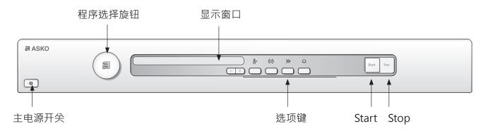
可通过旋转程序选择旋钮来选择程序。 选定的程序会在窗口显示。 使用选项键选择任何选项。
