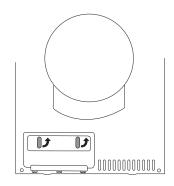
4. 取出冷凝器并用莲蓬头之类的工具清洗肋片。 请勿戳捅肋片间隙以免损坏冷凝器。清洁时, 请不要使用尖锐的金属器具。
