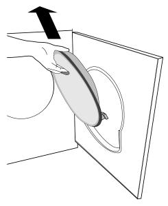
2. 打开线头过滤器,如图用拇指按压边缘。
