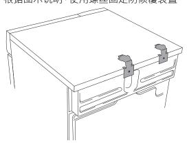
4. 将固定滚筒式干衣机前脚的塑料杯贴附在洗衣机的上盖。这个操作很重要. 因为唯有滚筒式干衣机的脚安放在塑料杯中. 您才能确保滚筒式干衣机正确地安置在洗衣机上。折断右侧脚杯的标签A 和左侧脚杯的标签B。
