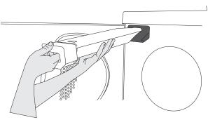
如果没有将机器连接到单独的排水管·则每次烘衣后必须排空冷凝水容器内的水。 取出冷凝水容器,排空水后再将容器放回原处。
