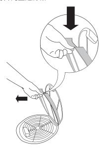
4. 用手或软布清除滤网各边的棉絮·如果需要·可以使用湿海绵和少量洗洁精擦去沉积物·用毛巾彻底擦干滤网。
