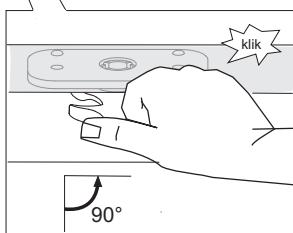
Пальцем отодвните замок вправо на 90° до щелчка. Замок дверцы заблокирован (в нерабочем состоянии).
