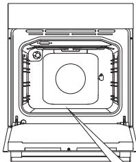
**1** Поверните ПЕРЕКЛЮЧАТЕЛЬ РЕЖИМА НАГРЕВА в положение AquaClean. ПЕРЕКЛЮЧАТЕЛЕМ ТЕМПЕРАТУРЫ установите температуру 70°C.
