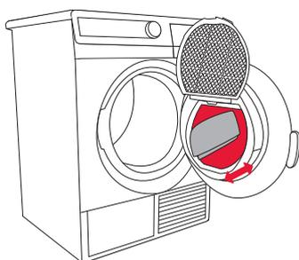
**2** Esfregue o filtro de pelos para remover a camada de fibras e de desfiaduras.
