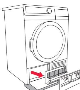
**2** Remova da máquina de secar roupa o filtro de esponja da bomba de calor tirando-o pela sua pega.
