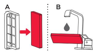
**3** Remova o filtro da sua pega. Limpe o alojamento do filtro com uma roupa húmida. Lave o filtro passando-o por água corrente, seque-o e volte a colocá-lo no devido lugar.
