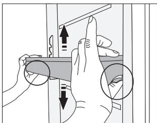
Durvju tvertņu/plauktu augstumu var regulēt atbilstoši vajadzībām, neizņemot no ierīces. Iespiediet abās pusēs esošos izciļņus un pārvietojiet tvertni/plauktu augšup vai lejup. Lai izņemtu tvertni no ierīces, paceliet līdz galam un izvelciet ārā.
