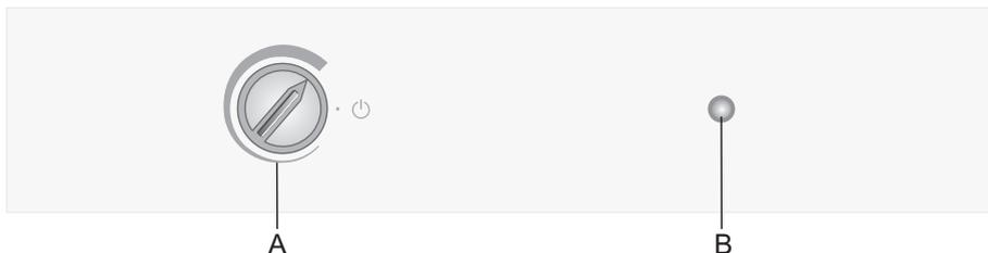
A Temperatūras iestatīšana un iekārtas ieslēgšanas / izslēgšanas poga
