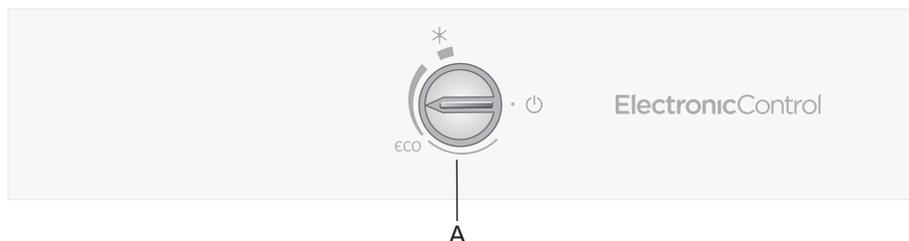
A Temperatūras iestatīšanas un ieslēgšanas / izslēgšanas poga
