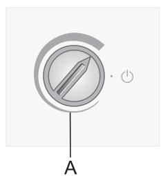
Jos huoneen lämpötila, johon laite on asennettu, on alle 16 °C, suosittelemme säätimen **A** asettamista **merkinnän paksuimpaan kohtaan**.
