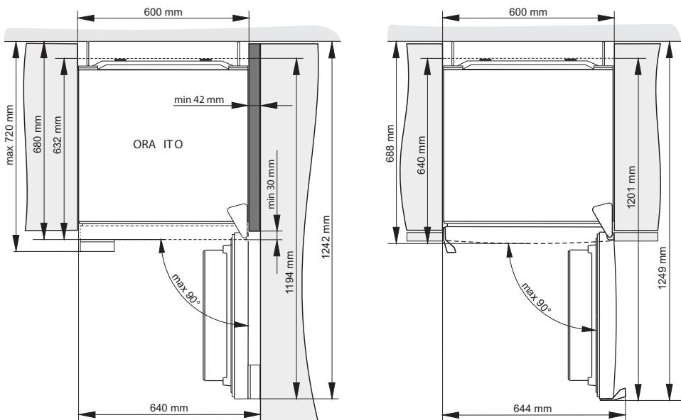
**Huomaa:** Jos laitteet sijoitetaan vierekkäin, kasteenestosarja (kondensoitumisen esto) on ostettava ja asennettava.
