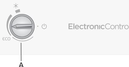
A Lämpötilan asetus ja päälle/pois -säädin
