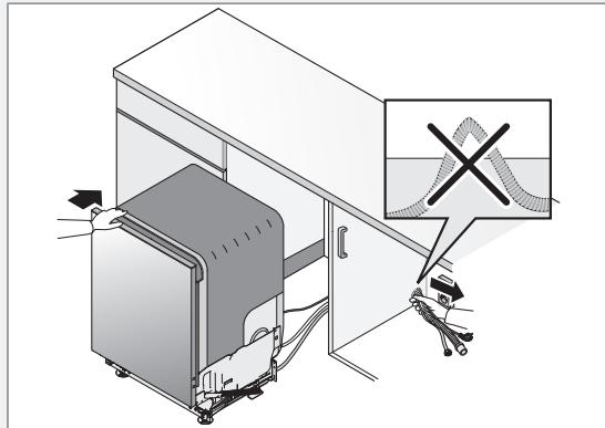
7 針對前腳做最後調整(洗碗機傾斜不得超過 5 公釐)，並鎖緊固定螺帽。
