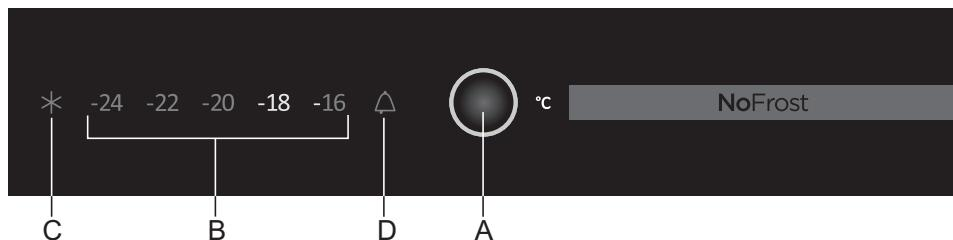
A Tipka za nastavitev temperature in vklop intenzivnega zamrzovanja
