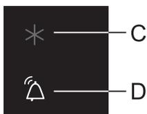
Ha a készülék belsejében a hőmérséklet túl magas, hangjelzés lesz hallható (szaggatott sípolás) és villogni kezd a **D** ikon.
