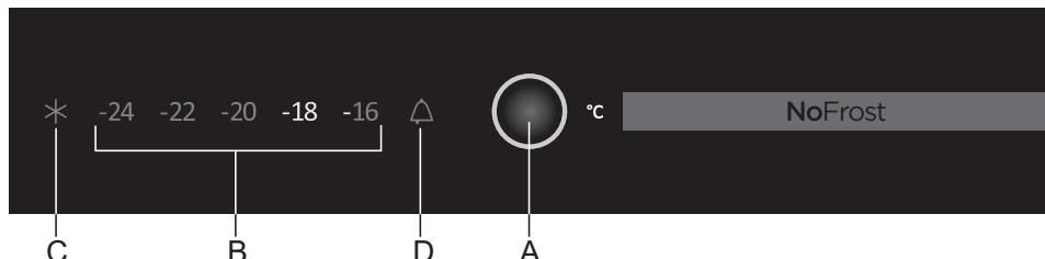
А Бутон за регулиране на температурата и понижаване температурата на охлаждане
