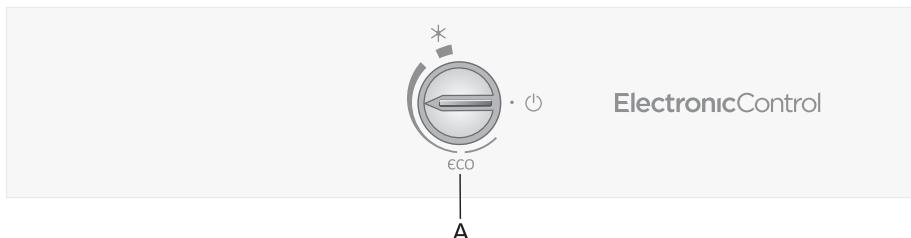
A Bryter for temperaturinnstilling, slå apparatet på/av og aktivering av Super freeze-funksjonen
