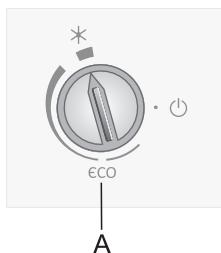
Bruk denne innstillingen når du har slått på apparatet for første gang, før rengjøring og når du setter inn store mengder matvarer.
