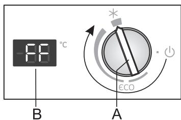
Vi anbefaler bruk av denne innstillingen før du rengjør apparatet og 24 timer før du setter inn en stor mengde mat. Aktivering av denne funksjonen sørger for at maten kjøles ned eller frysес raskere for å ta vare på vitaminer, mineraler, næringsstoffer og forlenge friskheten.
