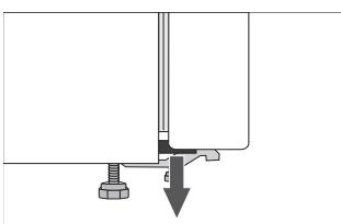
Det er montert avstandsstykker på dørhjørnene. Fjern dem, og sett de medfølgende pluggene inn i hullene (gjelder bare noen modeller).
