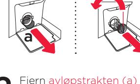
**2** Fjern avløpstrakten (a) før du rengjør filteret. Dreier filteret langsomt mot urviseren (b).
