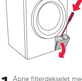
**1** Åpne filterdekselet med en flat skrutrekker eller tilsvarende.
