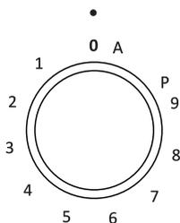
Поверните переключатель вправо в положение P. На цифровом индикаторе конфорки загорится символ P. Если уменьшить степень нагрева, режим максимальной мощности автоматически выключится.
