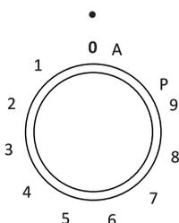
Поверните переключатель до конца вправо в положение А и удерживайте 2 секунды, пока не раздастся звуковой сигнал. Установите степень нагрева основного приготовления. На цифровом индикаторе конфорки будут попеременно высвечиваться символ А и установленная степень нагрева основного приготовления. По истечении нагрева на максимальной мощности конфорка автоматически переключится на заранее выбранную степень нагрева основного приготовления.
