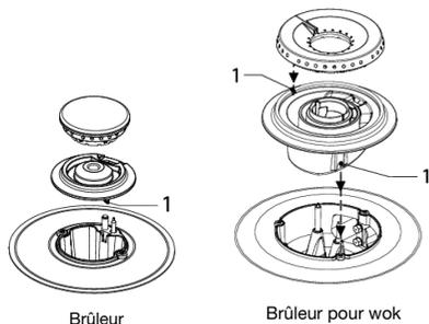
Suivez les encoches d'assemblage pour assembler les brûleurs (1).
