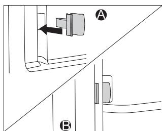
Kod montaže teleskopskih vodilica (potpuno izvlačenje) s katalitičkim ulošcima, umetnute priložene kačice u donje otvore na stenki peći, i kačice umetnute u vodilice. Te kačice namenjene su boljem učvršćenju vodilica.
