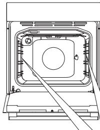
Odstranite žičane odnosno teleskopske vodilice.
