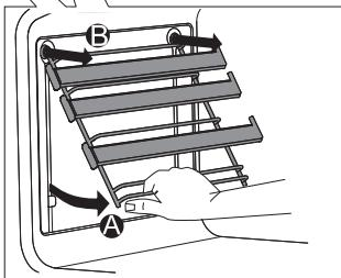
**A** Vodilice uhvatite na donjoj strani i povucite ih prema unutrašnjosti peći.
