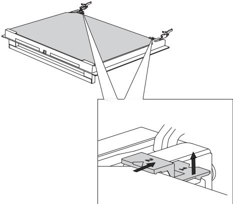
**1** Lagano podignite nosače na levoj i desnoj strani vrata (oznaka 1 na nosaču), te ih zatim lagano povucite van iz stakla (oznaka 2 na nosaču).
