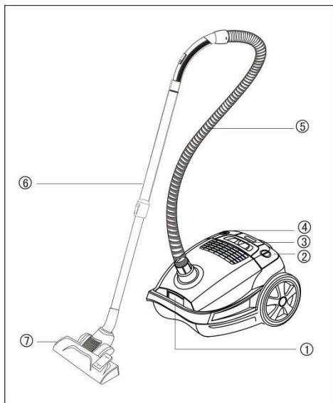
1. Фиксирующий затвор крышки
