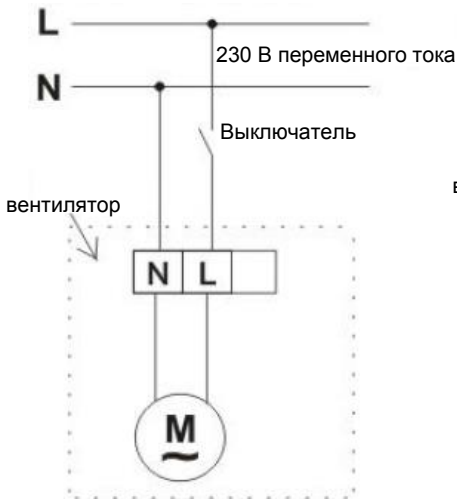
Схема электропроводки – Стандартные модели
