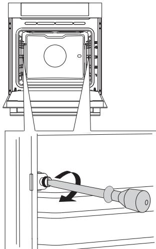
**1** Открутите винт с помощью отвертки.
