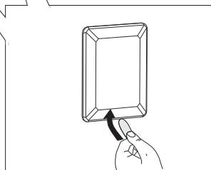
**1** С помощью отвертки снимите крышку.
