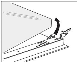
**2** Fassen Sie die Glasscheibe am unteren Rand an, heben Sie sie leicht an, damit sie aus dem Träger herauspringt und nehmen Sie sie heraus.
