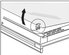
**3** Entfernen Sie die innere, dritte Glasscheibe (nur bei einigen Modellen), indem Sie sie leicht anheben und dann herausziehen. Entfernen Sie auch die Gummidämpfer von der Glasscheibe.
