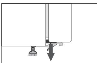
Suojakappaleet on asennettu ovien kulmiin. Irrota ne ja laita toimitukseen sisältyvät tulpat paikoilleen (vain joissakin malleissa).
