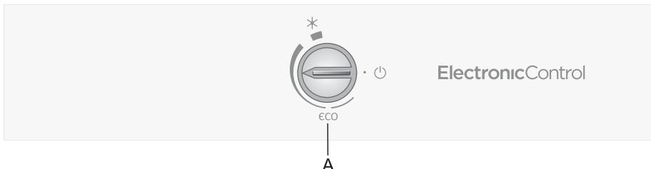
A Lämpötilan valintanuppi, laitteen kytkeminen pääälle/pois ja tehopakastustoiminnon käynnistäminen
