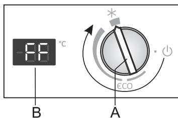
Suosittemme käyttämää tästä asetusta ennen laitteen puhdistamista tai 24 tuntia ennen kuin sinne lisätään suuri määrä ruokaa. Aktivoimalla tämän toiminnon varmistat, että ruoka jäähytetään tai pakastetaan nopeammin, niin että sen sisältämät vitamiinit, mineraalit, ravintoaineet ja maku sekä tuoreus säilyvät pidempään.
