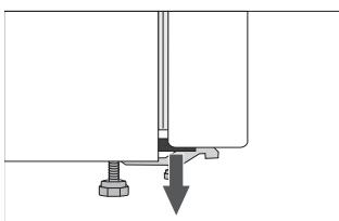
Suojakappaleet on asennettu ovien kulmiin.
