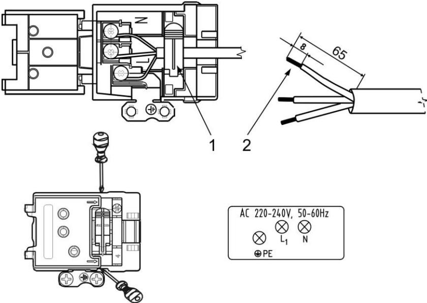
1. Abrazadera para impedir la extracción del cable
