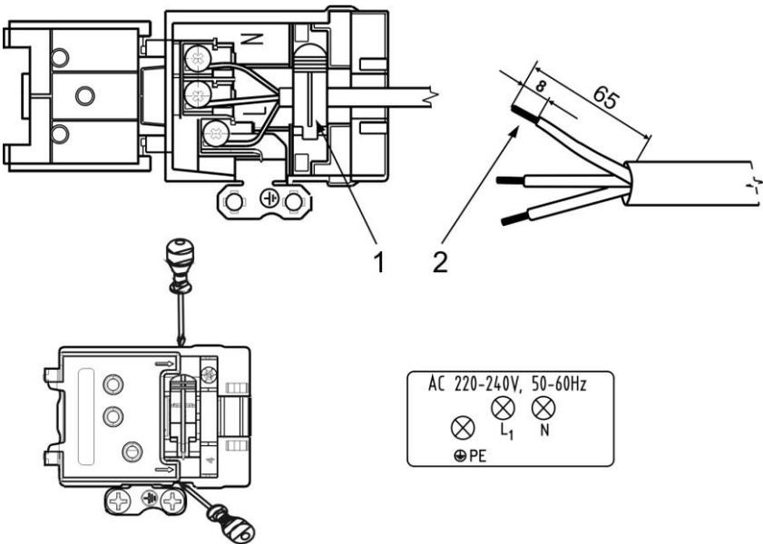
1. 防止电线断裂的环扣
