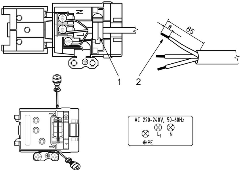
1. 防止电线断裂的环扣
