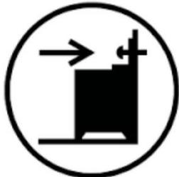
OPOZORILO: Da bi preprečili nagibanje ali prevračanje aparata, je treba namestiti stabilizatorje. Upoštevajte navodila za namestitev.
