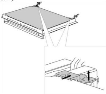
Немного приподнимите фиксаторы с левой и правой стороны дверцы (символ 1 на фиксаторе) и потяните в стороны от стекла (символ 2 на фиксаторе).
