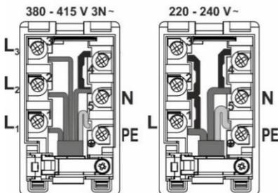
В случае неразъемного подключения к электросети установите до прибора размыкающее устройство с расстоянием между разомкнутыми контактами не менее 3 миллиметров.
