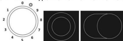
Вы можете изменить размер зоны нагрева конфорки в зависимости от диаметра и формы посуды. Для включения внешнего контура нагрева поверните переключатель конфорки до конца (слышен щелчок). Затем установите переключатель на необходимую степень нагрева.
