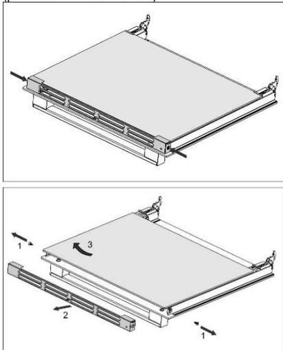
Išsukite varžtus ant durelių kairėje ir dešinėje pusėse ir ištraukite viršutinį rėmelį. Dabar galite ištraukti durelių stiklą.
