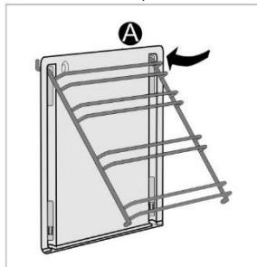
Nasadte katalytické vložky na závěsné rošty. Horní část závěsného roštu nasuňte do horních otvorů "A" v katalytické vložce.
