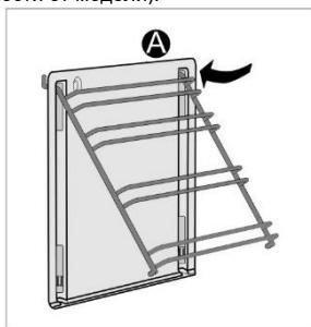
Наденьте вкладыш на направляющие: вставьте прутья направляющих в отверстия в верхней части вкладышей "А".
