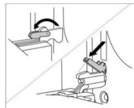
3. Медленно закрывайте дверцу, пока фиксаторы не упрутся в прорези на дверце. Приблизительно при 15° (относительно закрытой дверцы) дверцу немного приподнимите и извлеките из гнезд шарниров.
