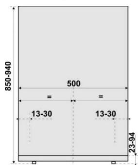
Закрепите кронштейн на стене с помощью прилагаемых в комплекте винтов и дюбелей. Если прилагаемые винты и дюбели не обеспечивают надежный монтаж кронштейна, используйте
