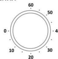
Для установки времени поверните переключатель таймера по часовой стрелке и затем обратно, чтобы установить более точное время. Максимальное время таймера 60 минут. По прошествии установленного времени в течение 5 секунд раздается звуковой сигнал.
