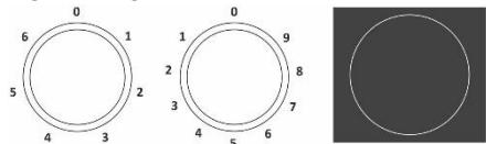
Степень нагрева конфорок устанавливается бесступенчато (1-9) или ступенчато (1-6).
