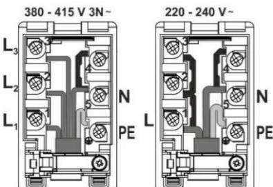
В случае неразъемного подключения к электросети установите до прибора размыкающее устройство с расстоянием между разомкнутыми контактами не менее 3 миллиметров.
