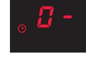
Berør bryteren for tidsinnstilling. Displayet "CL" endres til "0", og symbolet (klokke) blinker for å vise aktiv kokesone.
