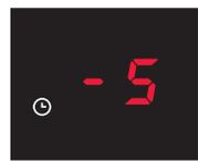
Näytölle vaihtuu "X" (X ... asetettu arvo). Aseta nyt arvo "1x - 9x". Arvo tallennetaan ja ajastin käynnistyy.
