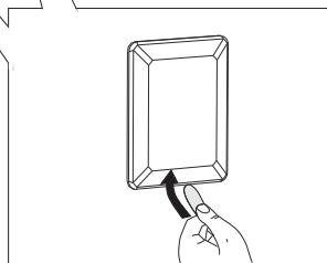
**1** С помощью отвертки снимите крышку.
