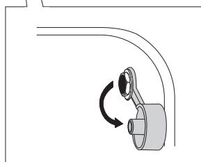
**1** Выньте металлическую заглушку (гнездо для зонда расположено в переднем верхнем углу на правой стенке духовки).
