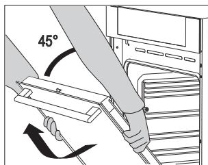
**3** Медленно закрывайте дверцу до угла 45° (относительно закрытого положения дверцы), затем приподнимите ее и аккуратно снимите.
