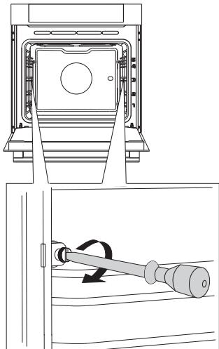
**1** Открутите винт с помощью отвертки.
