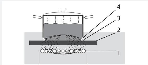
La bobine (1) de la table de cuisson (2) génère un champ magnétique (3). Si l'on place un récipient à fond ferromagnétique (4) au dessus de la bobine, des courants induits se forment dans le fond du récipient.
