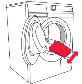
**3** Nach jedem Waschvorgang wischen Sie die Gummidichtung an der Tür ab.
