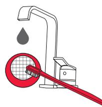
**2** Reinigen Sie die Gitter mehrmals unter fließendem Wasser.
