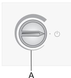
**Uključenje:** gumb **A** okrećite u smjeru kazaljki na satu.
