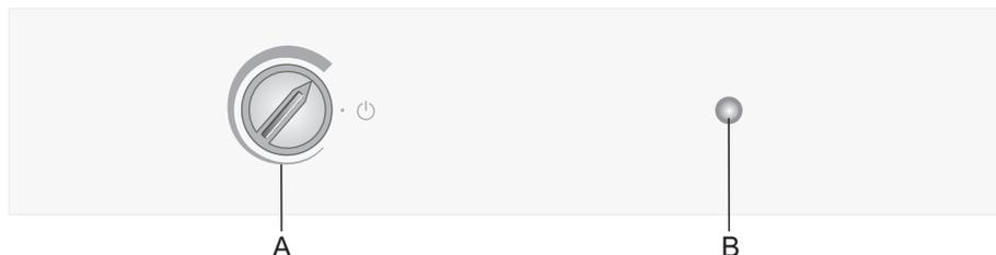
**A** Gumb za podešavanje temperature i uključenje/isključenje uređaja
