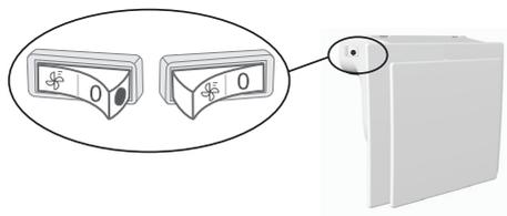
Kad su ventilator i ionizator uključeni, na prekidaču je vidljiva crvena točka.
