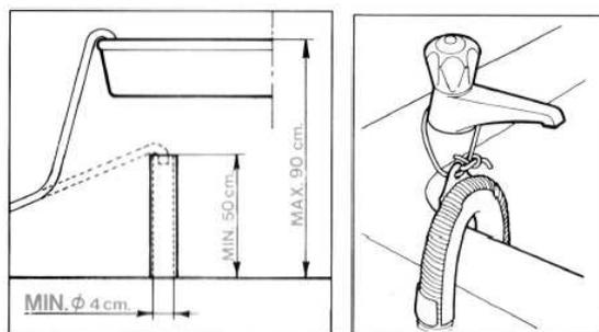
2. 排水管務必固定好，以防脫落
