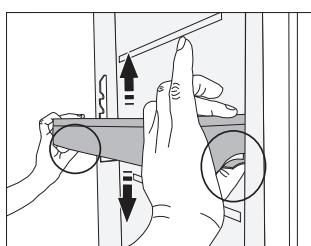
Înălțimea recipientelor pentru ușă poate fi ajustată fără a fi nevoie să îndepărtați recipientele din aparat. Pur și simplu trageți către dumneavoastră cele două mâneră de pe fiecare parte a recipientului și glisați recipientul în sus sau în jos.
