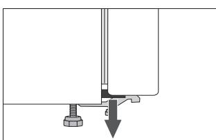
Colțurile ușilor sunt prevăzute cu distanțiere protectoare. Acestea trebuie îndepărtați și înlocuiți cu suporturile atașate, care trebuie introduse în orificiile respective (doar în cazul anumitor modele).
