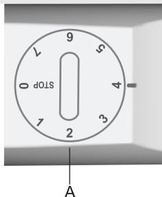
Pour mettre l'appareil en marche, tournez le bouton du thermostat **A** dans le sens des aiguilles d'une montre vers la position **7**.
