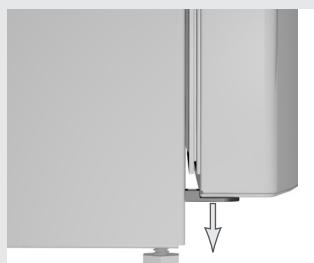
Les coins de la porte sont protégés par des entretoises. Enlevez-les et insérez à la place, dans les orifices, les caches livrés avec l'appareil (uniquement pour certains modèles).
