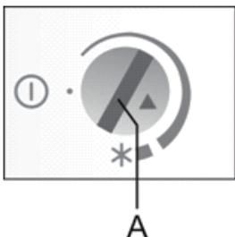
Поверните переключатель **A** по часовой стрелке в область, обозначенную толстой линией.
