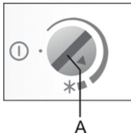
Рекомендуемое положение переключателя термостата — **посередине между тонкой и толстой областью линии**. Изменение температуры окружающей среды влияет на температуру внутри прибора. В соответствии с этим регулируйте температуру в приборе переключателем. Положение переключателя в области, обозначенной толстой линией, означает более низкую температуру (холоднее), положение в области, обозначенной тонкой линией, — более высокую (теплее).
