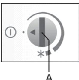
Поверните переключатель **A** обратно, чтобы знак стрелки был в положении  $\ominus$  (прибор выключен, но находится под напряжением).
