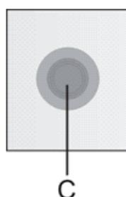
Лампочка **C** мигает, если температура в приборе поднялась выше допустимого значения. Лампочка автоматически погаснет, когда температура в морозильнике достигнет значения, при котором нет опасности порчи продуктов (см. раздел «Устранение неисправностей»).
