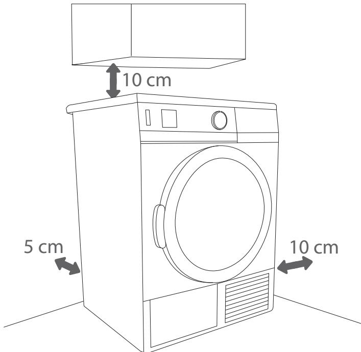
Вентиляционные проемы и отверстие на передней или задней стенке сушильной машины должны быть свободными.
