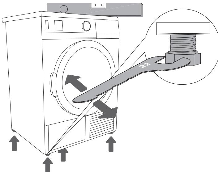
Выровняйте прибор по горизонтали и по вертикали, вращая регулируемые ножки, которые позволяют выровнять прибор на  $\pm 1$  сантиметр. Используйте уровень и гаечный ключ №22.
