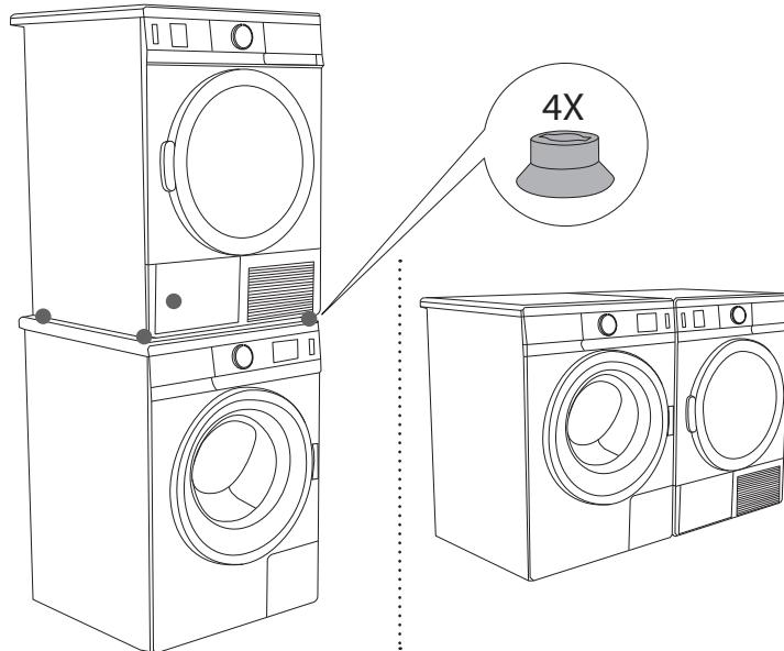
Сушильную машину можно устанавливать на стиральную машину с использованием ножек-присосок, которые прилагаются в комплекте, или рядом со стиральной машиной.
