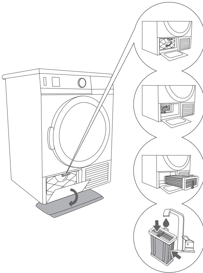
**1** Откройте наружную крышку конденсатора: возмитесь за ручку слева и потяните вниз. Снимите внутреннюю крышку: поверните фиксатор вниз и снимите крышку.
