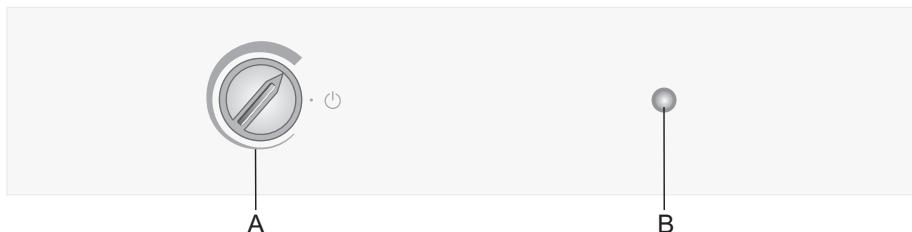
А Переключатель вкл./выкл. и установки температуры
