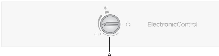
А Переключатель вкл./выкл. и установки температуры
